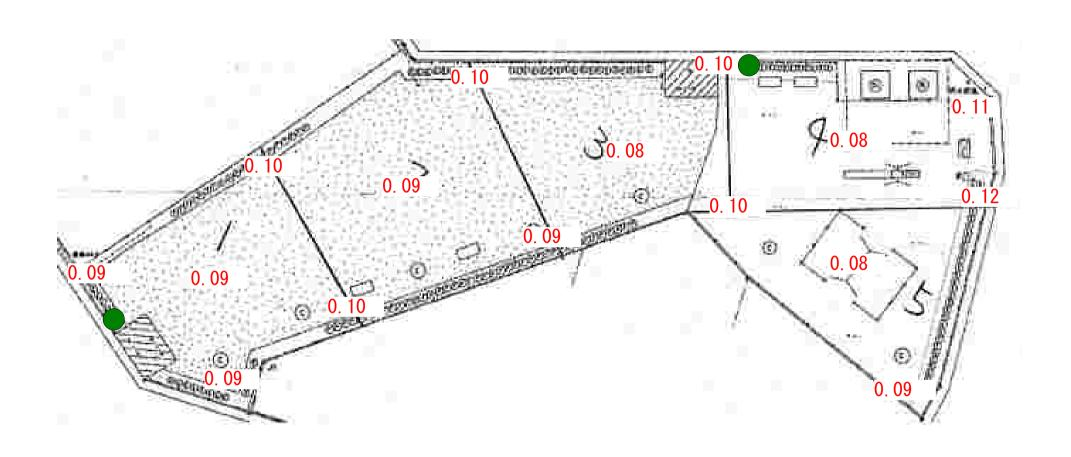
単位:毎時マイクロシーベルト 測定高:地上50cm 測定機器:NaIシンチレーション式サーベイメータ (日立アロカ社製:TCS-172B) 測定日:平成26年1月17日
