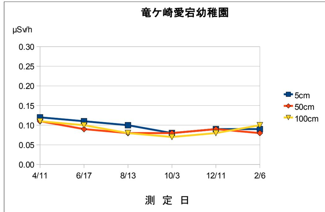
測定は、NaIシンチレーション式サーベイメータ（日立アロカ社製：TCS-172B）を使用しています。
