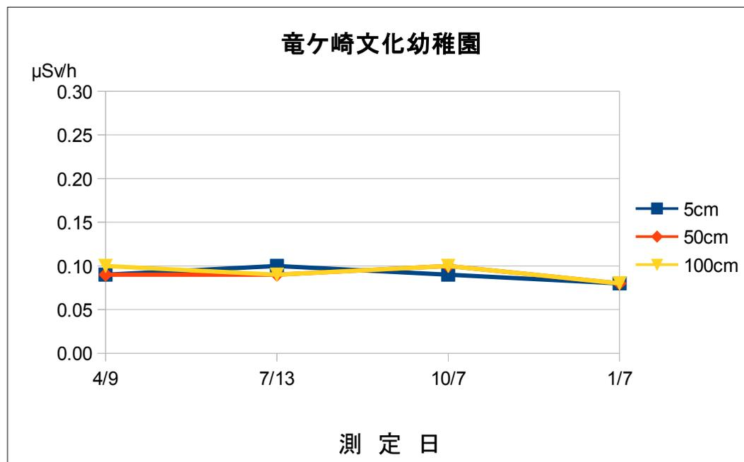
測定は、NaIシンチレーション式サーベイメータ（日立アロカ社製：TCS-172B）を使用しています。
