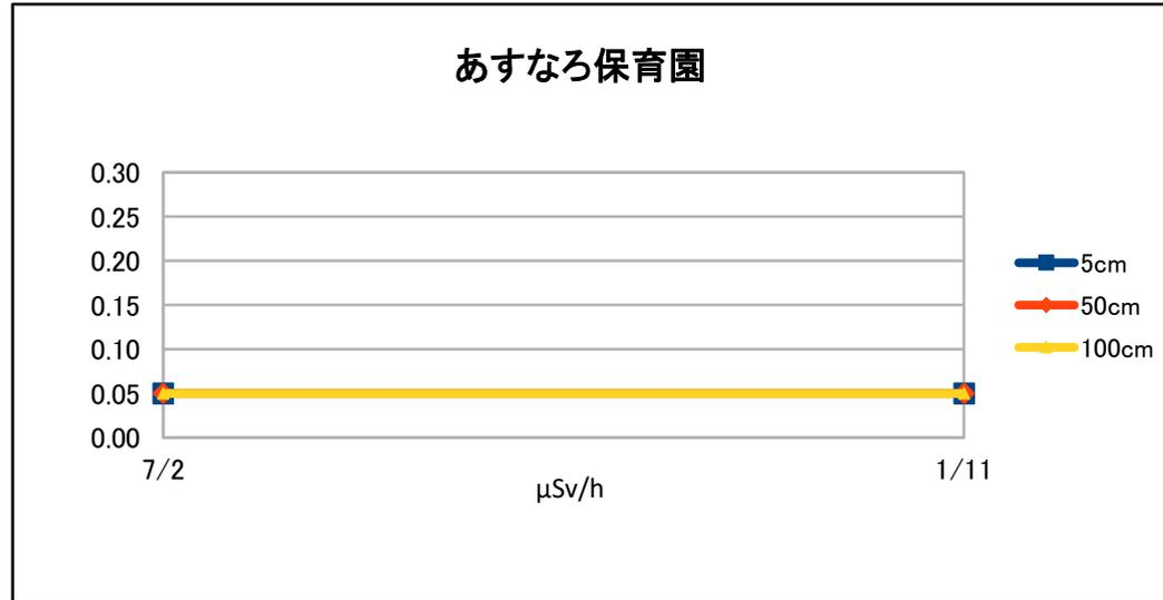
測定は、NaIシンチレーション式サーベイメータ（日立製作所社製：TCS-172B）を使用しています。
