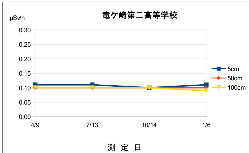
測定は、NaIシンチレーション式サーベイメータ（日立アロカ社製：TGS-172B）を使用しています。
