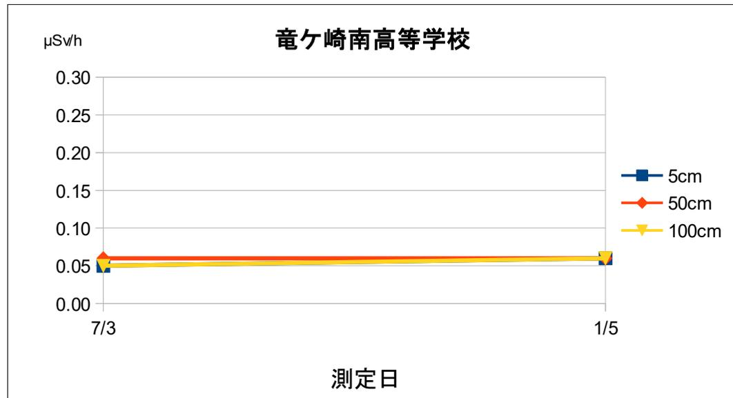
測定は、NaIシンチレーション式サーベイメータ（日立製作所社製：TCS-172B）を使用しています。
