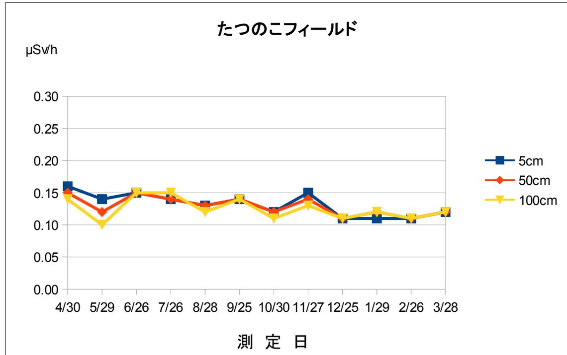
測定は、NaIシンチレーション式サーベイメータ（日立アロカ社製：TCS-172B）を使用しています。
